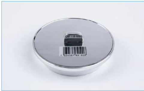
강철 용기에 보관된 측정 대기중인 필터
