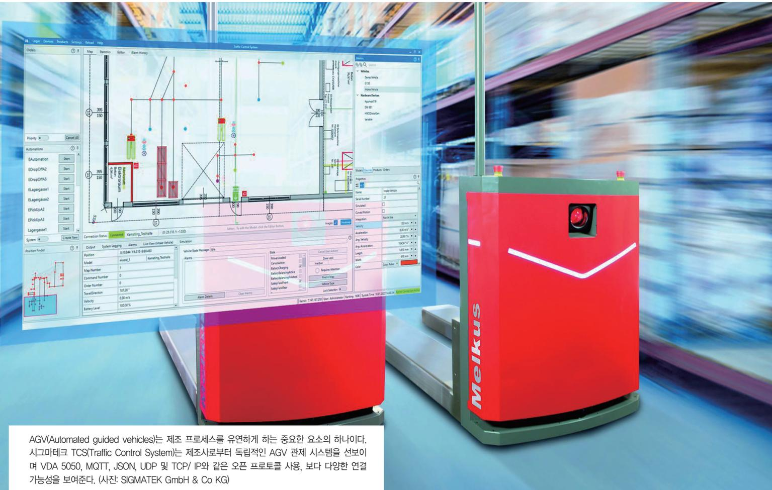
AGV(Automated guided vehicles)는 제조 프로세스를 유연하게 하는 중요한 요소의 하나이다. 시그마테크 TCS(Traffic Control System)는 제조사로부터 독립적인 AGV 관제 시스템을 선보이며 VDA 5050, MQTT, JSON, UDP 및 TCP/ IP와 같은 오픈 프로토콜 사용, 보다 다양한 연결 가능성을 보여준다. (사진: SIGMA TECH GmbH & Co KG)
