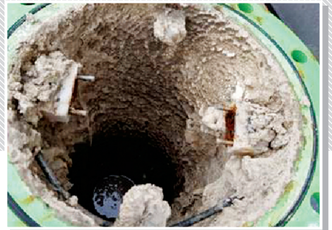
설치 3개월 스케일 생성 모습
